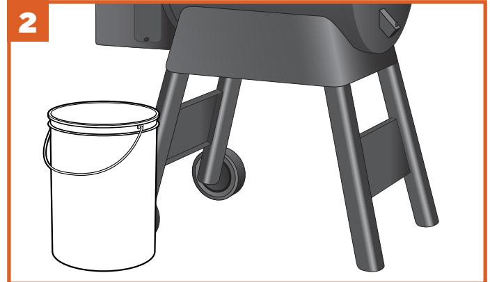
Settu nægilega stórt ílát undir hurðina þar sem kögglnir eru losaðir burt.
